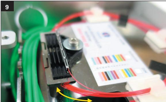
Nach dem Spleissen und einlegen der Spleisschütze soll eine Sichtkontrolle auf gute Faserführung und Faserbeschädigungen durchgeführt werden.
