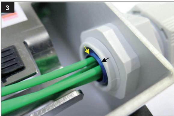
Der blaue Krimp-Aufteiler wird soweit eingeführt, sodass er bündig mit dem Innengewinde der Kabelverschraubung liegt.
