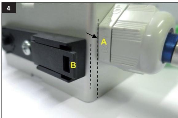
Es ist darauf zu achten, dass die eine Kante (A) der Kabelverschraubung gerade zum Gehäuse fixiert wird, damit der Hutschienen Halter zugänglich bleibt.
