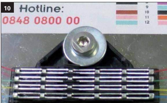
Der Spleisshalter ist für maximal 4 ANT Krimp Spleisschütze ausgelegt.
