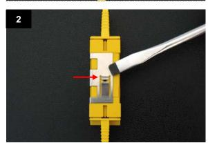
Auf der Unterseite, mit einem Schraubenzieher, den kleineren Winkel flach herunterdrücken. Sonst sitzt das Mittelstück später nicht richtig im Gehäuse.
