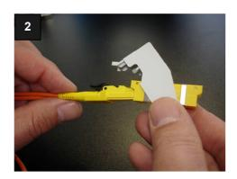
Das Patchkabel in das Mittelstück des DIN-Schienen E-2000™ Moduls einstecken, welches im Gehäusedeckel montiert ist.
