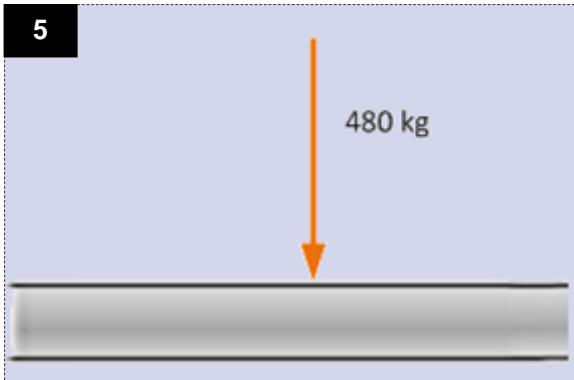
Es darf max. 480 kg Druck auf das Kabel ausgeübt werden.
