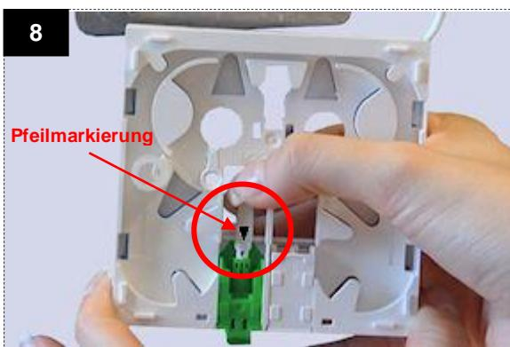
DiaLink von hinten her durch die Öffnung auf die Vorderseite führen und in den Adapter einstecken. Es ist zu beachten, dass die schwarze Pfeilmarkierung oben liegt und in die Führungsrolle des Adapters geführt wird.
