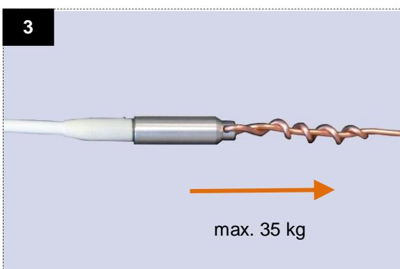
Per la posa del cavo, inserire un filo di Ø 1,5 mm nell'occhiello del cappuccio e bloccarlo torcendolo. Fissare l'altra estremità del filo alla sonda tira cavo.
