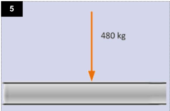
La pression exercée sur le câble ne doit pas dépasser une charge maximale de 480 kg.
