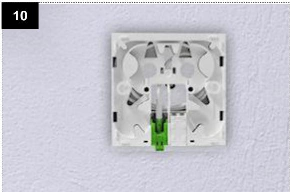
Dose wieder drehen und auf den Metallrahmen aufrasten. Es ist darauf zu achten, dass das Kabel nicht eingeklemmt wird.
