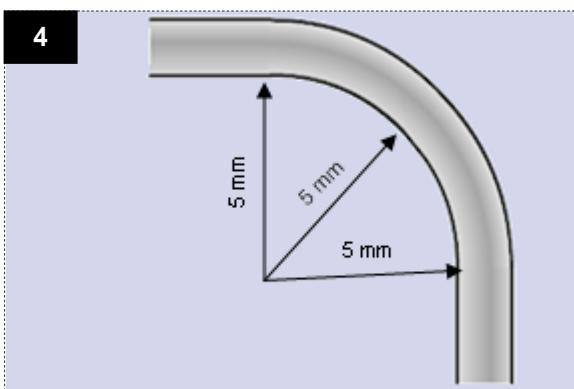
Durante l'installazione del cavo, tenere in considerazione che il raggio di curvatura non deve essere inferiore a 5 mm. Questo per garantire il corretto funzionamento della fibra.
