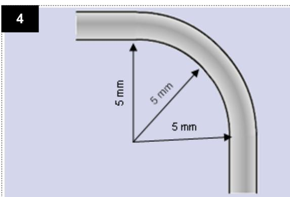
Beim Verlegen ist darauf zu achten, dass der Radius von 5 mm nicht unterschritten wird. Dieser Radius darf auch während des Betriebes nicht unterschritten werden. Das Kabel nicht knicken.
