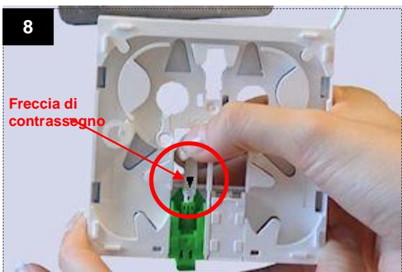
Fare passare il DiaLink dalla parte posteriore della presa ottica e posizionarlo di fronte all'accoppiatore con la freccia nera rivolta verso l'alto.
