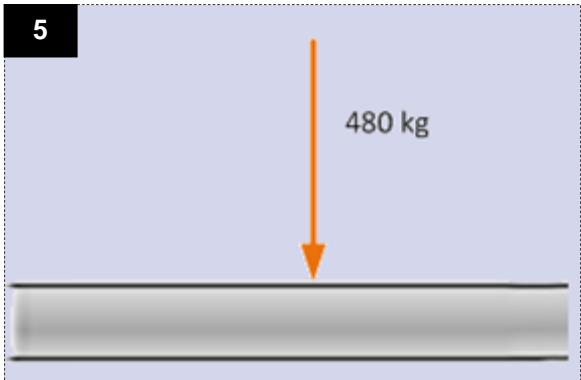
Il cavo resiste fino ad una pressione massima di 480 kg.
