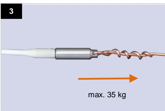
Zum Einziehen ein Draht mit Ø 1,5 mm durch die Öffnung im Steckerschutz ziehen und durch Verdrehen fixieren. Das andere Ende des Drahtes an der Einzugsrute befestigen.
