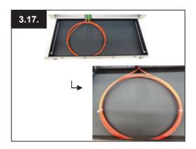
Der Bündelader-Ring kann mit Kabelbinder oder auch mit Klettverschluss individuell zusammengebunden werden.
