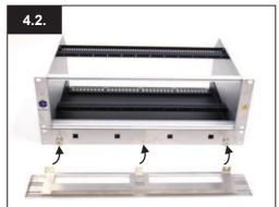
Die Kabelwanne kann jetzt von unten her unter diese drei Schrauben eingeführt werden.
